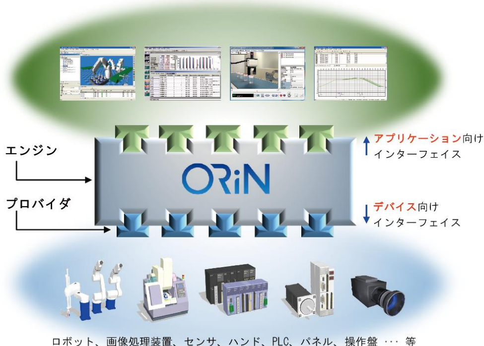
図 8－4 ORiN によるデバイス・アプリケーションの接続イメージ 出所) https://www.orin.jp/
