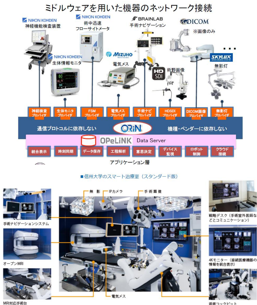
図 8 - 6 OPeLiNK による医療機器・アプリケーションの接続仕様
