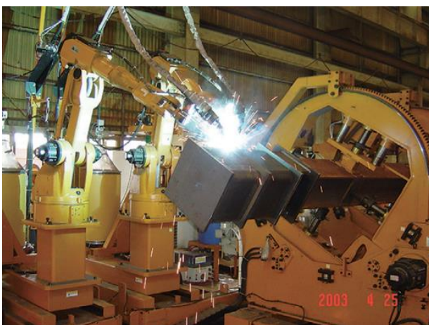
図 6-19 建築鉄骨の自動溶接・ロボット化は 2000 年代初期にはかなり普及
