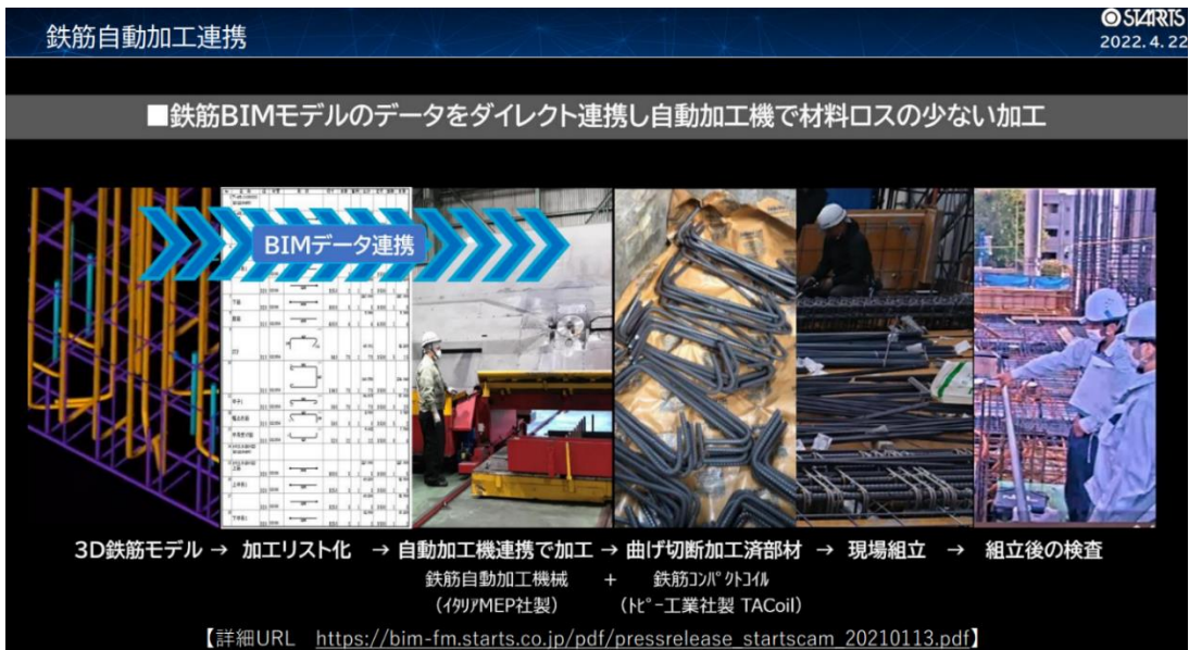
図 6-18 BIM に鉄筋加工サプライチェーンの自動加工 (委員会 スターツコーポレーション 関戸博高他講演資料より引用)
