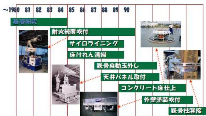
図 5-18 清水建設の初期 (1980~2000) の建設ロボット開発
